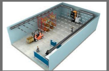
U-förmiges Push/Pull-System mit 1 Filtereinheit und 1 Lüfter
