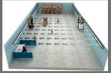
Parallel angeordnetes Push/Pull-System mit 2 Filtereinheiten und 2 Lüftern
